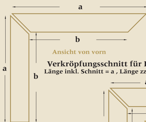
Gehrungsschnitt für Fensterumrahmung Länge inkl. Schnitt = a , Länge zzgl. Schnitt = b
